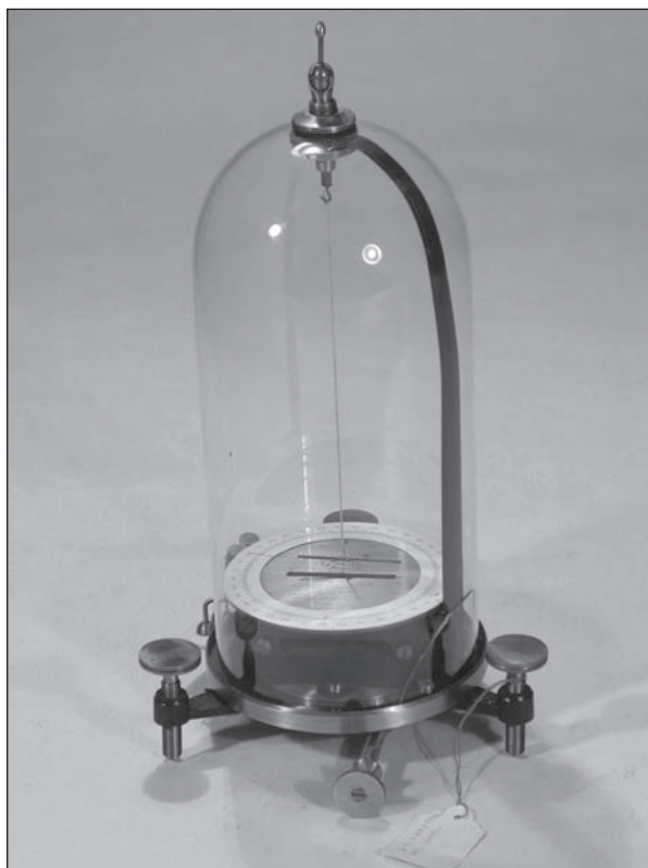
Galvanometro del Nobili montato in ottone con sistema astatico, Museo Strumentaria, Liceo L. Ariosto
